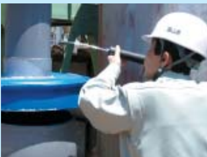
工場の立入調査（有害ガス測定）
