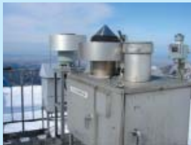
酸性雨調査 降水試料自動捕集装置
